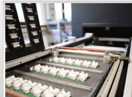
Гнёзда RJ45 приготовленные для пайки
