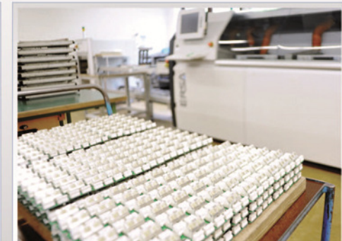
Готовые гнёзда RJ45 после пайки
