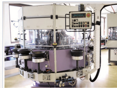
Одновременная сборка разъёмов серий MCX и MMCX
