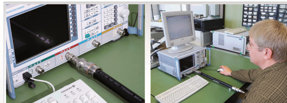
Оптимизация разъёма на анализаторе сигнала и спектра R&S ZVB 8
