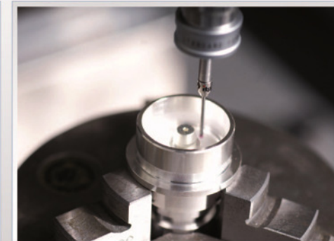
Измерение детали на основе 3-D координатного измерения
