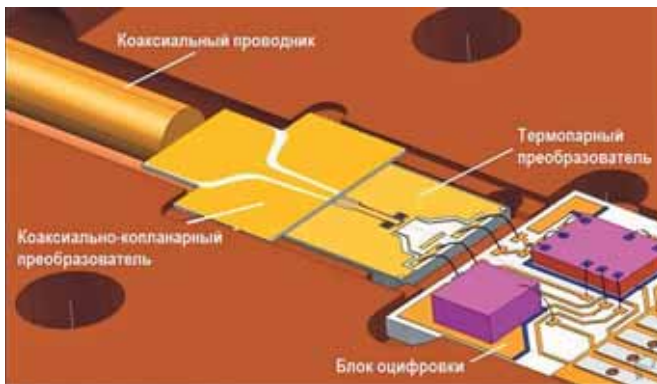
Входной каскад ВЧ-тракта с коаксиально-копланарным преобразователем
