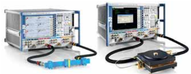
Измерение параметров материалов в волноводе (слева) и измерение параметров пленок на основе резонатора (справа)
