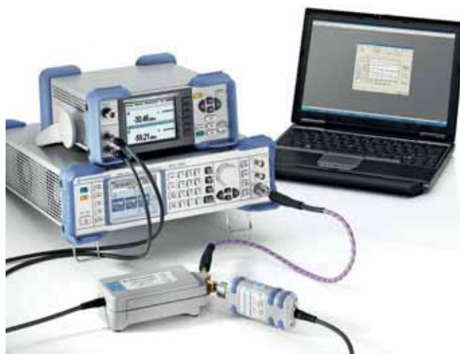
Измерительная установка для калибровки преобразователя мощности NRP-Z55
